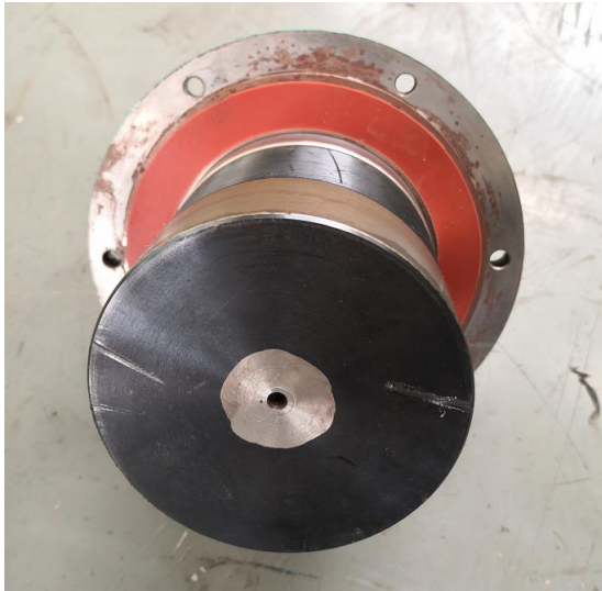
600 次手动松闸试验后的铁芯端面
