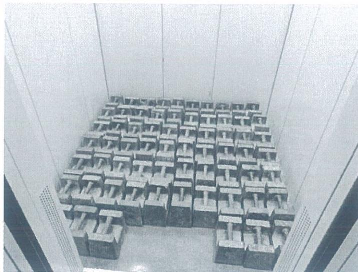
图示为轿厢内均匀装载 125%额定载重量的载荷
