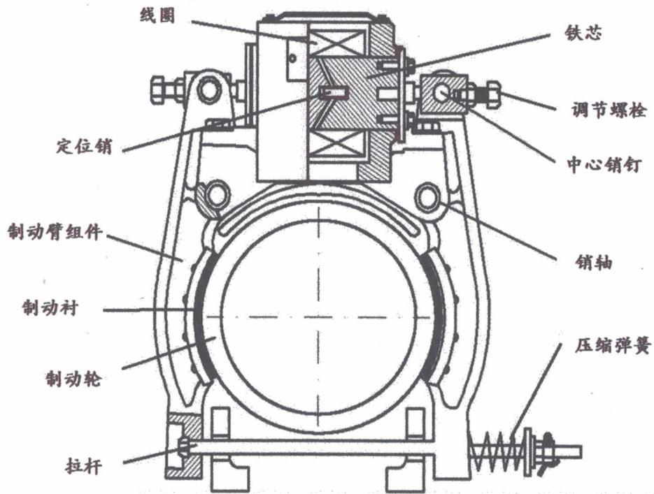
图 3 鼓式制动器 (单铁芯)
