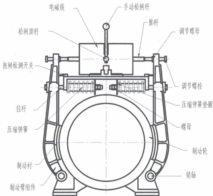
图 1 鼓式制动器 (双铁芯)
